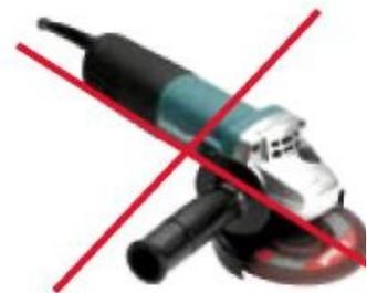
Категорически запрещено использовать углошлифовальную машину с абразивным кругом («болгарку»), т.к. выжигается не только полимерное покрытие, но и цинк в результате чего начинается бурный процесс коррозии.
