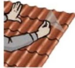
Не допускается эксплуатация изделий с защитной пленкой после монтажа. Пленка снимается в процессе монтажа в избежание ее «прикипания» полимерному покрытию.
