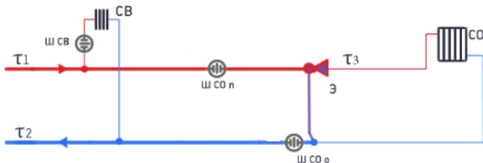
Рисунок 4 – Схема подключения потребителей к двухтрубной тепловой сети (при наличии внутренней системы отопления), в качестве регулятора температуры используется элеватор (СО – система отопления, Э – элеватор, СВ – система вентиляции)
