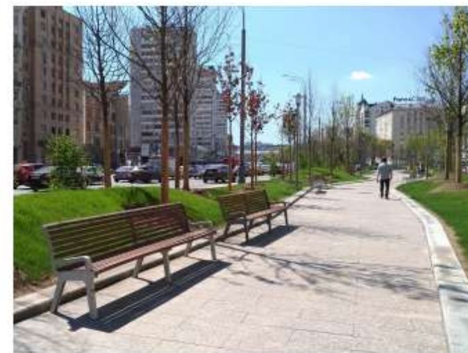
Использование геопластики в качестве буфера от проезжей части, Москва
